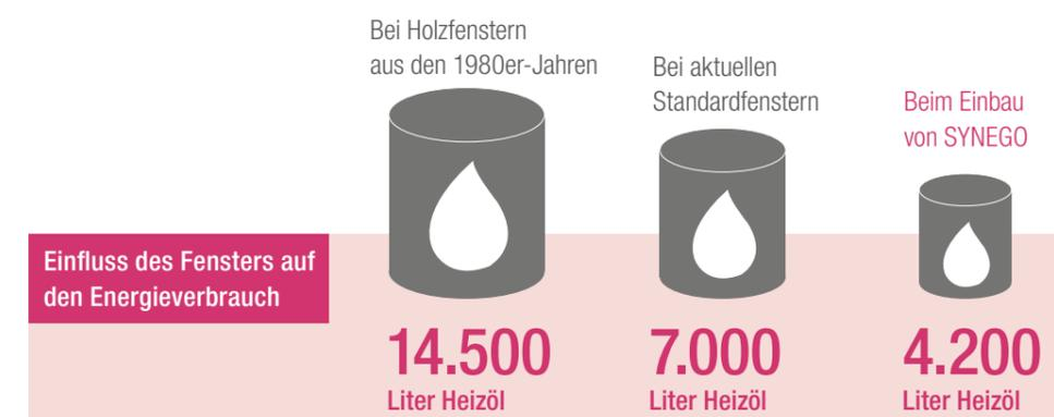
Rechnung: Fensterfläche von 25 m<sup>2</sup>, Heizölverbrauch in 25 Jahren; Holzfenster mit  $U_w = 2,79 \text{ W/m}^2\text{K}$ , Standardfenster mit  $U_w = 1,36 \text{ W/m}^2\text{K}$ ; SYNEGO mit  $U_w = 0,66 \text{ W/m}^2\text{K}$
